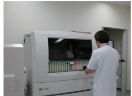
輸血検査：全自動輸血検査装置
