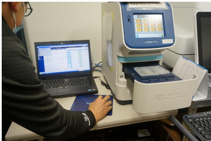
図1 リアルタイムPCR機(Thermo Fisher Scientific, StepOnePlus)
