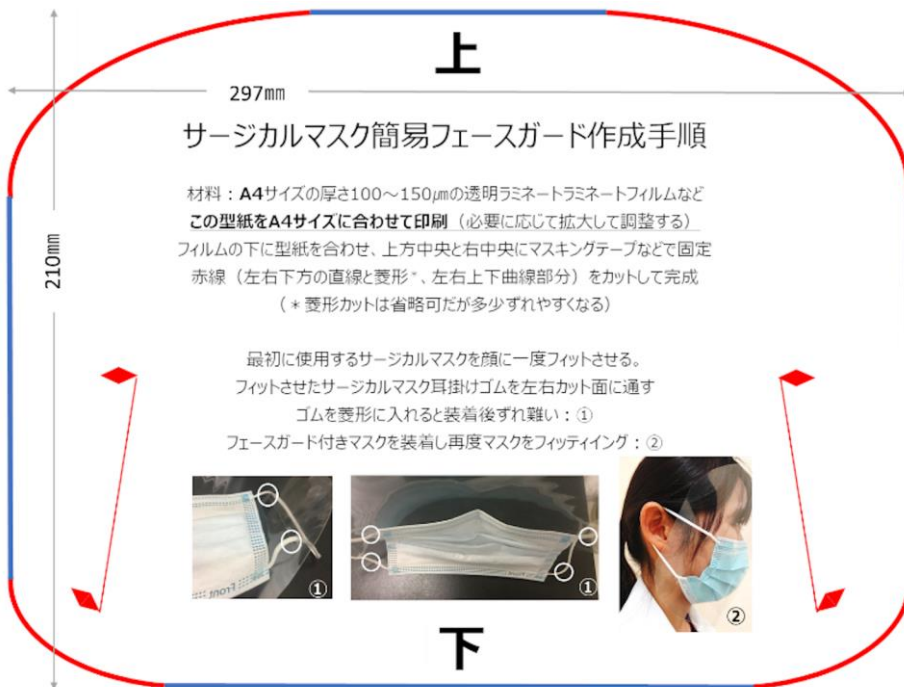
図 考案した感染防護フェースガード作成シート(実際は実寸)および装着写真
