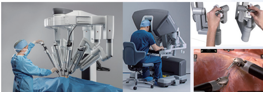
写真1：Da Vinci Surgical System™ Xi ロボットアーム（写真左側） サージャンコンソール（写真中央：外科医はビデオカメラによる3次元画像を見ながら手術を行います） ロボットの手術鉗子を動かす外科医の手元のイメージです（写真右上） 手術鉗子は関節が複数あり自由度の高い動きが可能です（写真右下）
