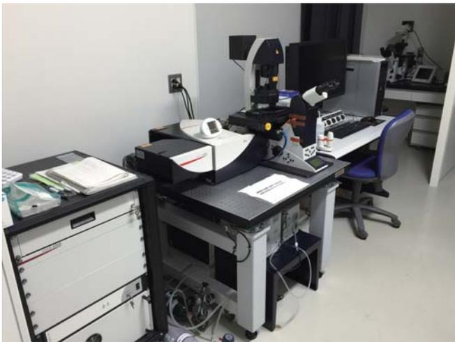
図2 センターに導入したSTED顕微鏡
